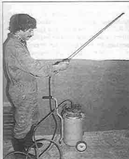
Abb. 11: Kalkspritze zum „Weißeln“, Kosten 600 – 800 DM.
