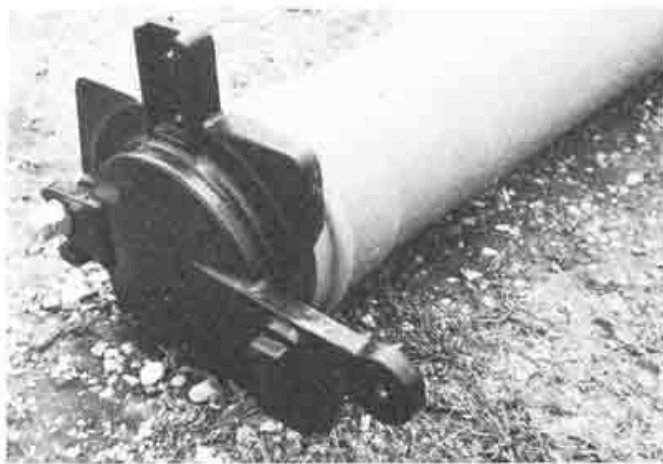
GÜLLESCHIEBER für Spülleitung in zwei verschiedenen Ausführungen.
