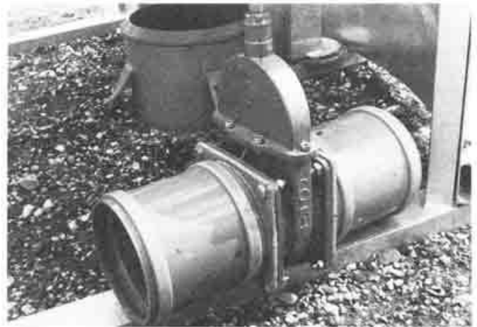
GÜLLESCHIEBER für Spülleitung in zwei verschiedenen Ausführungen.
